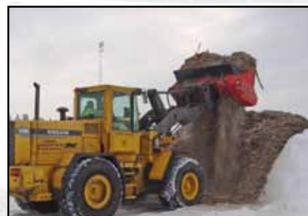
Lufting av biologisk kompost
